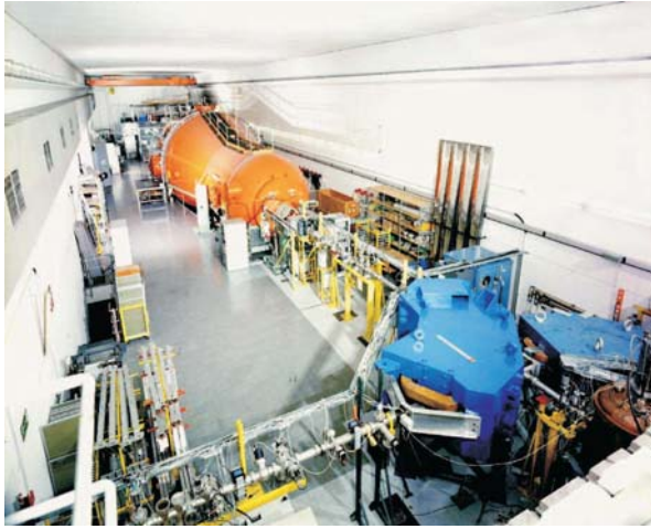
Abb. 4.8: Der 15 MV Tandembeschleuniger des Maier-Leibnitz-Laboratoriums in Garching. Man sieht den Drucktank des Beschleunigers und im Vordergrund den 90^\circ Analyse magneten.
