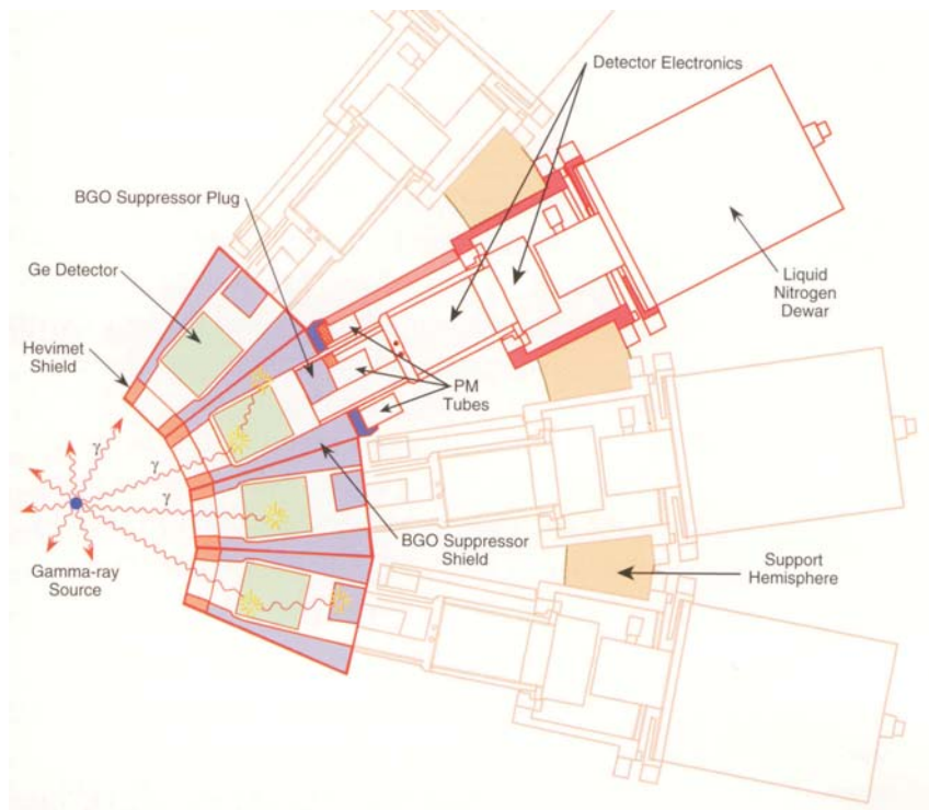
Abb. 6.24: Schnitt durch das Gammasphere Spektrometer mit Germaniumdetektoren und BGO-Anti-Compton-Detektoren.
