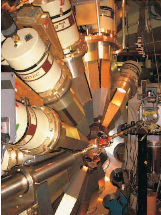
Abb. 6.25: Das Foto zeigt eine Hälfte des Gammasphere Spektrometers mit den Detektoren, die auf die Targetposition entlang des durchgehenden Strahlrohres gerichtet sind.
